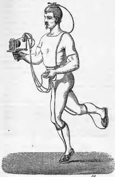
Fig. 27. — Coureur muni des appareils destinés à enregistrer les diverses allures
